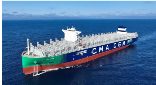
LNG Dual-Fuel 23,000 TEU Container ship
